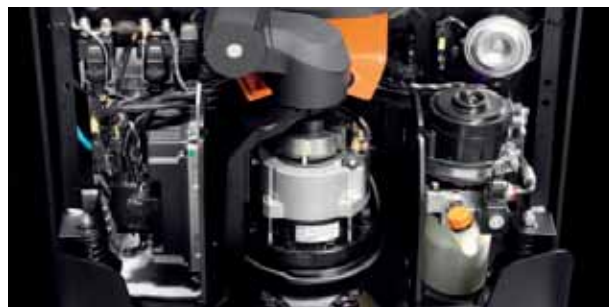
Der fest eingebaute Motor hat keine beweglichen Kabel
