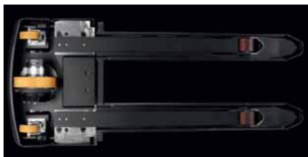
Das einzigartige BT Fünfrad-Chassis des HWE100 gewährleistet hervorragende Stabilität und Kontrolle
