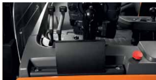
Über die E-Bar-Universalschiene lassen sich Zusatzgeräte wie PCs, Terminals, Barcode-Leser usw. leicht anbauen
