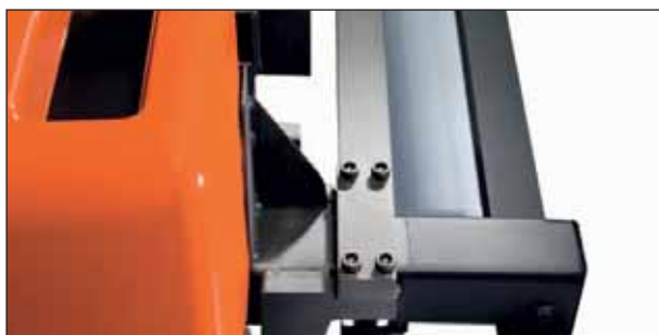
Der HWE100S verfügt über dieselben Leistungsmerkmale wie der HWE100, hat aber zusätzlich gespreizte Stützarme für den Transport unterschiedlicher Palettengrößen. Die Hubhöhe beider Modelle beträgt 2 m.
