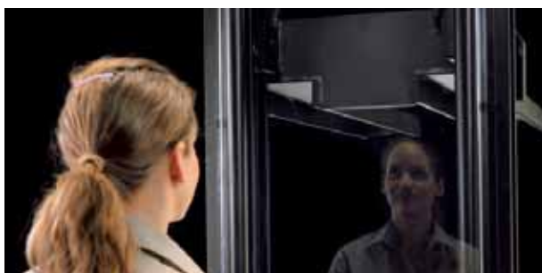
Dank des BT Totalview-Konzepts sind die Gabelspitzen von der Bedienposition aus sichtbar
