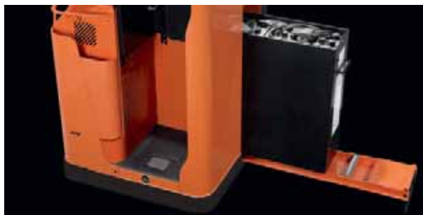
Dank Rollenbahn und integriertem Batterietisch lässt sich die Batterie bei der S-Serie leicht seitlich wechseln
