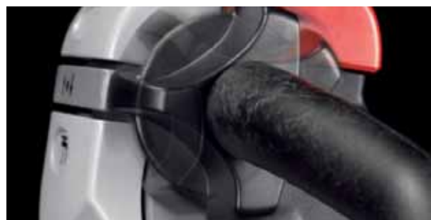
Die Click-2-Creep-Funktion ermöglicht das Manövrieren des Fahrzeugs mit senkrecht stehender Deichsel
