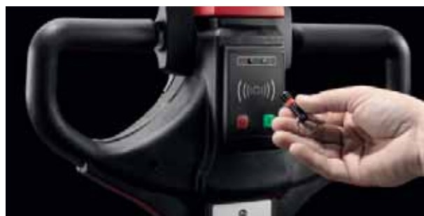
Bei der „Smart Access“-Zugangskontrolle werden über persönliche Schlüssel/Codekarten automatisch die passenden Leistungsparameter für jeden Bediener eingestellt
