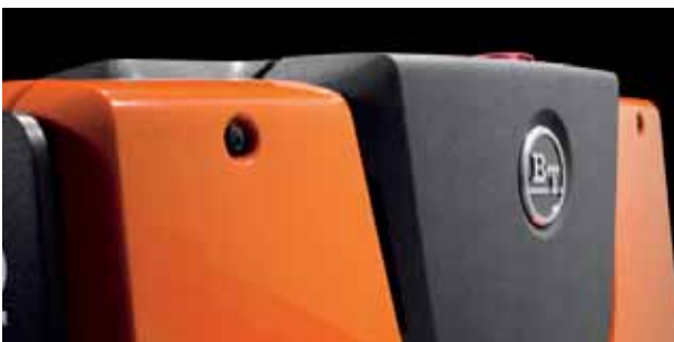
Für den Schnellzugriff ist die Haube mit nur zwei Schrauben gesichert
